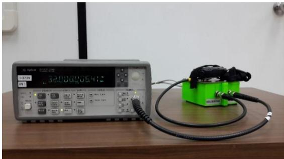
**Figura 3.** Receptor de campo eléctrico, circuito depurador y contador de frecuencia.
