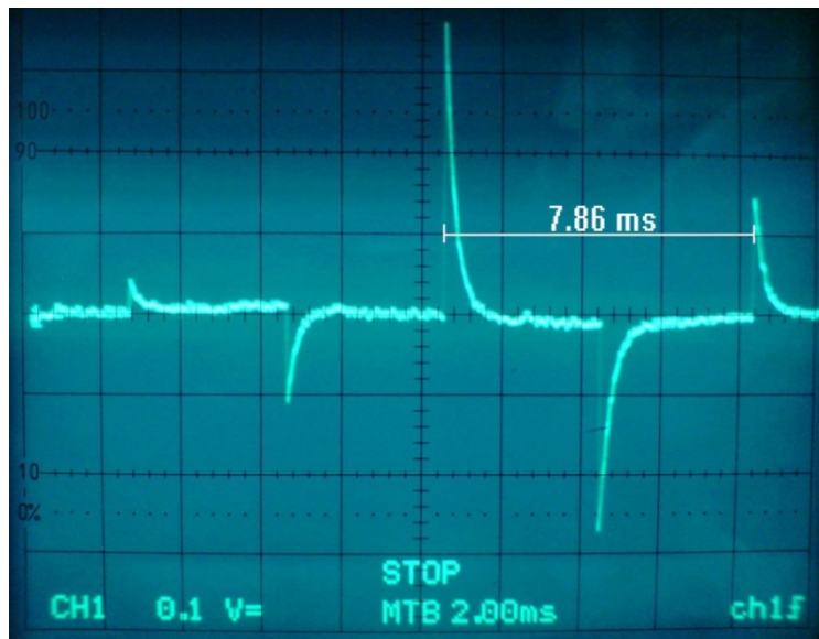
Figura 5.6 Señal generada a partir del reloj digital.
